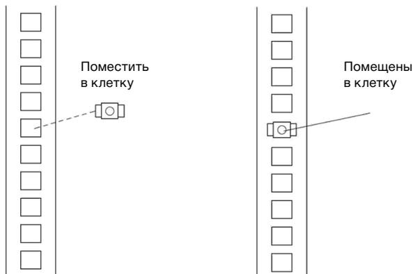
Совместите монтажные отверстия на кронштейне с установленными в клетку гайками, вставьте и поверните винт в затянутом положении.
